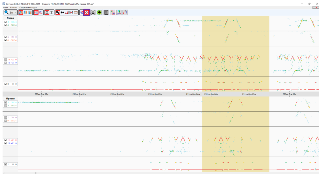
Рисунок 29. Режим отображения Б-скан в виде цветографии
